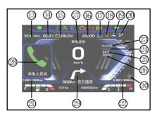
(3) Consumo medio di carburante per 100 chilometri Visualizza il consumo medio di carburante di una motocicletta su 100 chilometri. È possibile selezionare l'unità metrica L/100km o l'unità imperiale Mpg. Nota: i dati sul consumo di carburante sono visualizzati come valori teorici e possono differire dai valori reali.
