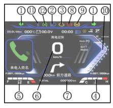
Il cruscotto di questo modello può essere impostato in modalità interfaccia diurna, interfaccia notturna o modalità automatica (il cruscotto passa automaticamente all'interfaccia diurna o notturna in base alle condizioni di luce dell'ambiente).
